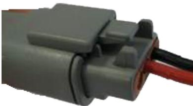
7. Branchez l'autre extrémité du câble d'adaptateur d'engagement à distance sur le réplicateur de port (broche 10 et broche 11) sur le câble EZ-Pilot qui est connecté au Port B sur l'CFX-750 display.
